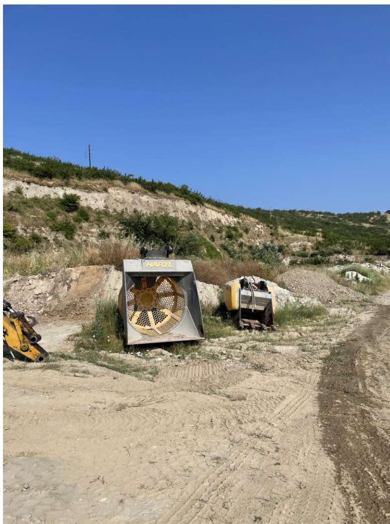
Φωτογραφία 3. Μηχάνη κοσίνησης για τον διαχωρισμό υλικών και σπαστήρας
