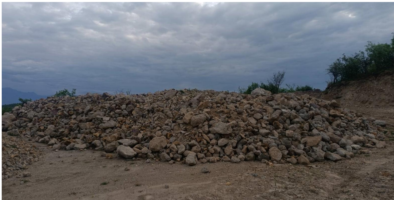
ΦΩΤΟ 3: Άποψη της προσωρινής απόθεσης των στείων υλικών που προκύπτουν από την κοσκίνιση του εξορυγμένου υλικού σε σταθερό επικλινές κόσκινο.
