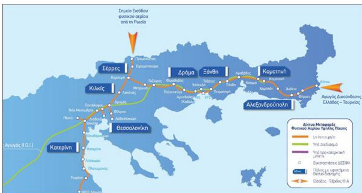
Εικόνα 6-44: Όδευση του κεντρικού αγωγού μεταφοράς φυσικού αερίου
